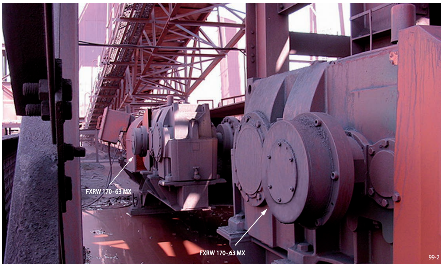
南非铁矿石传送带，有3个驱动变速箱并带有RINGSPANN公司的FXRW 170 MX逆止器。
